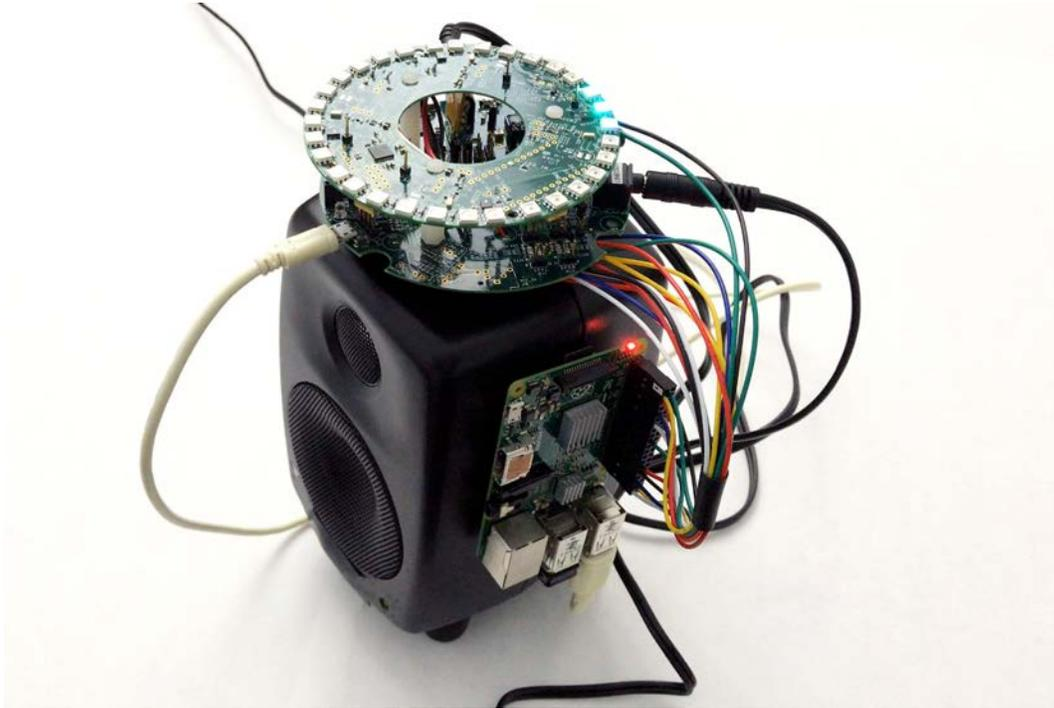
*Figure 8. DS20924 mounted on speaker*
